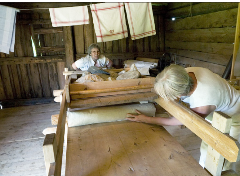
Med gott samarbete och handkraft drivs trämengeln. När den flyttades från en vind i ett hus i grannsocknen plockades den ner. Det svåraste var sedan att få rätt balans på stenarna i kistan när den plockades ihop, berättar Lisbeth Vestin och Lilly Wahlström.
