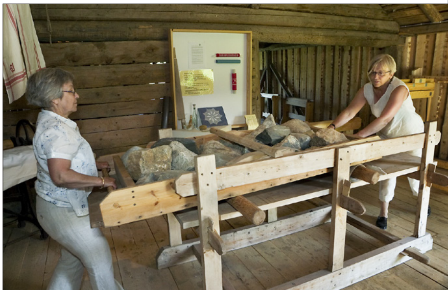
Med gott samarbete och handkraft drivs trämengeln. När den flyttades från en vind i ett hus i grannsocknen plockades den ner. Det svåraste var sedan att få rätt balans på stenarna i kistan när den plockades ihop, berättar Lisbeth Vestin och Lilly Wahlström.
